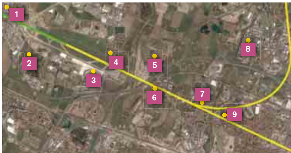
Figura 2 - Localizzazione delle centraline di rilevazione del rumore. Le linee gialle indicano le direttrici nominali di decollo lato Bologna
